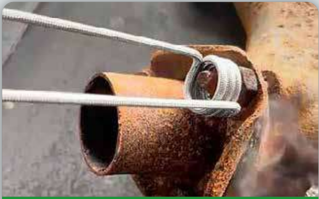
UNSEIZING AN EXHAUST MANIFOLD - DÉGRIPPAGE D'UN COLLECTEUR D'ÉCHAPPEMENT Coiled front wire inductor Ø21 Powerduction 10R
