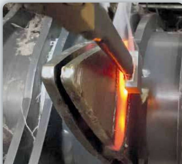
ROUND BALERS ROTOR TEETH STRAIGHTENING - REDRESSAGE DE DENTS DE ROTOR DE PRESSE À BALLES ROND Inductor L-X1/B1 Powerduction 220LG
