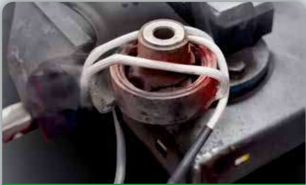
BUSHING REMOVAL - EXTRACTION D'UN SILENTBLOC Flexible inductor Powerduction 10R
