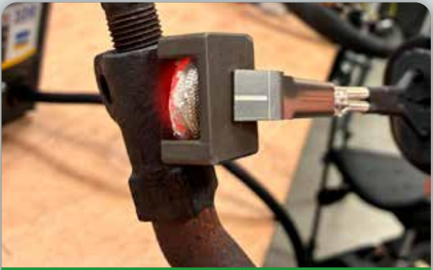
UNSEIZING STEERING BALL JOINT - DÉGRIPPAGE D'UNE ROTULE DE DIRECTION Inductor 18R/B5 Powerduction 18R
