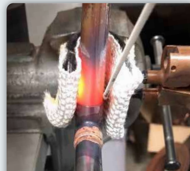
BRAZING COPPER PIPE - BRASAGE TUYAU CUIVRE Inductor L90 Braz 16 Powerduction 110LG
