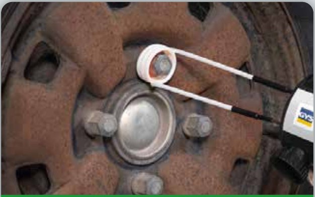
UNSEIZING WHEEL NUTS - DÉGRIPPAGE D'ÉCROUS DE JANTES Coiled front inductor Ø30 Powerduction 10R
