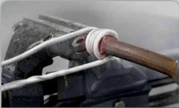
UNSEIZING STEERING BALL JOINT - DÉGRIPPAGE D'UNE ROTULE DE DIRECTION Flexible inductor Powerduction 10R
