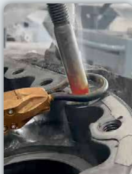
RELEASING ENGINE STUDS - DÉGRIPPAGE DE GOUJON DE CARTER Inductor S180/D30 Powerduction 37L
