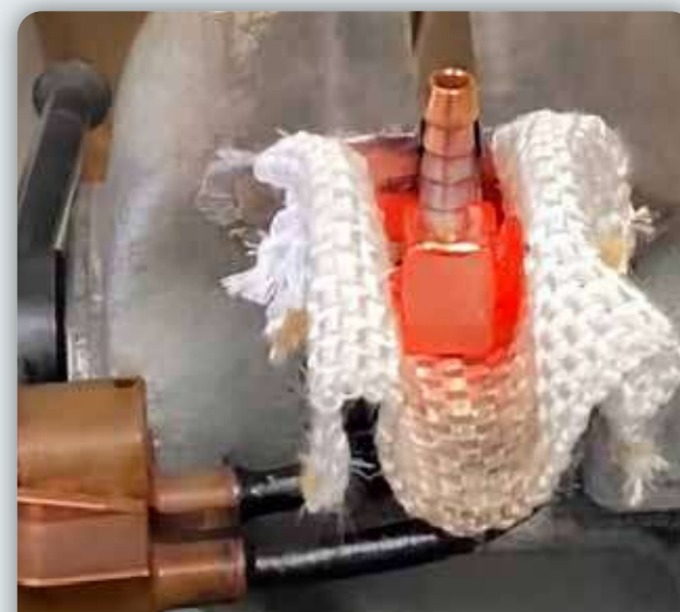
BRAZING BRASS PARTS - BRASAGE PIÈCE LAITON Inductor L90 Braz 28 Powerduction 160LG
