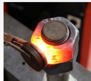
▶ Aquecimento antes de soldar
