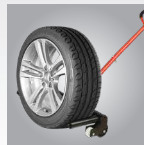
Para ajustar a jante no cubo da roda
