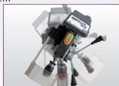
› Cabeça de perfuração inclina até \pm 45^\circ
