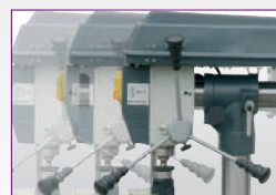
› Alcance variável, deslocando a cabeça de perfuração
