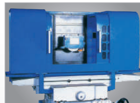
Guarda salpicos total (instalado de fábrica)
