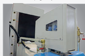
Extrator paralelo controlado por NC e dispositivo de compensação no cabeçote
