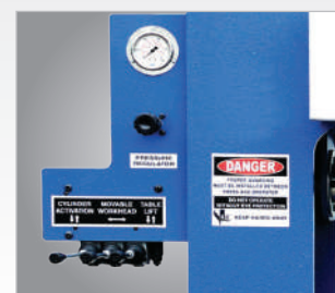
▶ Alavanca manual sensível à pressão e manômetro
