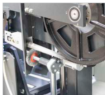
Escova de remoção de limalhas acionada eletricamente
