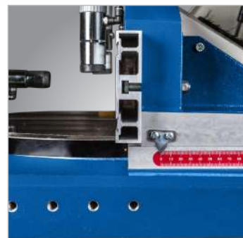
Batente continuamente ajustável
