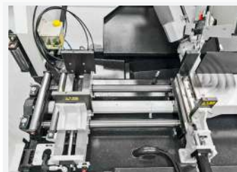
Alimentação de material através de fuso de esferas
