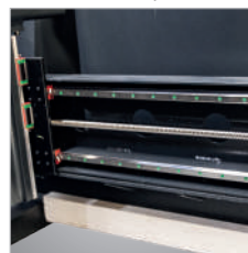
▶ Eixo X guiado linearmente através de parafuso de esferas via servomotor
