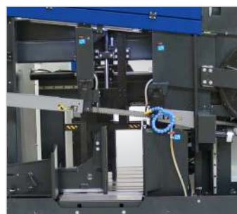
A inclinação de 7° e o tensionamento hidráulico da fita de serra aumentam a sua vida útil
