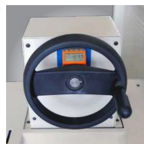
MTBS 2103 F ▶ Operação do batente traseiro a partir da frente da máquina via volante e contador
