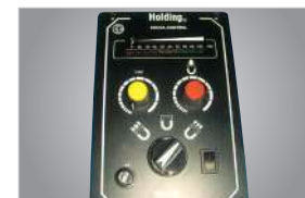
Desmagnetizador automático para base eletromagnética
