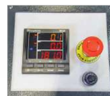
▶ Fácil de usar, com display digital para os valores atuais de dobra e para definir os parâmetros
