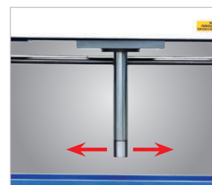
▶ Cilindro hidráulico deslocável lateralmente
