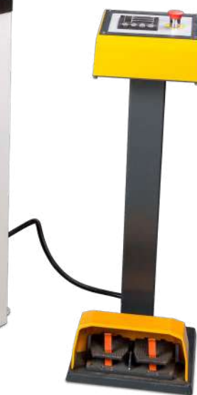
▶ Painel de controlo com display digital e interruptor de paragem de emergência
