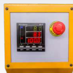
▶ Painel de controlo com display digital e interruptor de paragem de emergência
