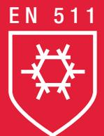
A norma EN 511 especifica os requisitos e métodos de ensaio para luvas de proteção contra o frio convectivo ou de contacto frio até - 50 ° C.
