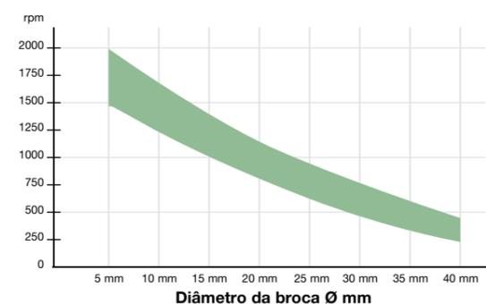
Intervalo ótimo de velocidade de perfuração em rpm
