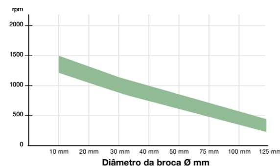
Intervalo ótimo de velocidade de perfuração em rpm
