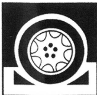
Colocar calços de roda à frente e atrás dos pneus que não devem ser levantados antes de prosseguir.
