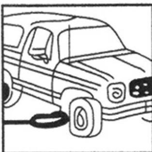
Centrar sempre o macaco no eixo de uma superfície estrutural plana e reforçada.
