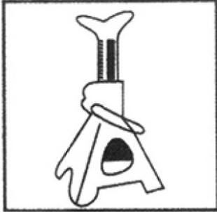
O peso deve ser suportado por um conjunto de suportes de macaco com a capacidade adequada antes de se poder efetuar qualquer trabalho de inspeção no veículo. Não ultrapassar a capacidade nominal, sob risco de perda de carga.
