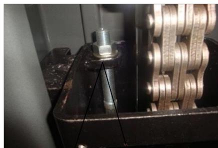
Rodar a porca para ajustar o comprimento do cabo para o nivelamento dos braços
