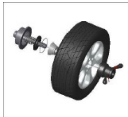
Eixo principal - cone adequado (cabeça grande para dentro) - roda - porca de pega rápida
