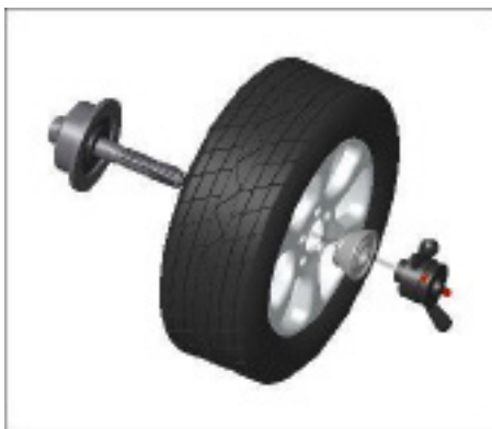
Eixo principal-roda- Cone adequado (cabeça pequena virada para dentro)-porca de pega rápida
