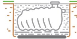
A seleção do local de instalação deve ser feita de modo que o equipamento receba toda a água oleosa produzida nas instalações. Se a instalação estiver localizada numa área com elevado conteúdo de areia, é essencial instalar uma câmara de retenção de areia a montante do equipamento.
